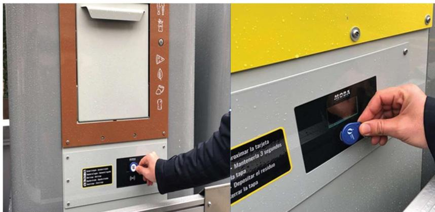
Figura 2. Funcionamiento de apertura de los contenedores mediante llaveros identificativos. Fuente: Ayuntamiento de Mataró, 2023.
