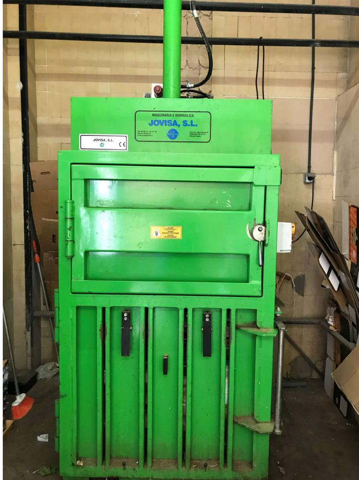
Figura 3. Compactadora hidráulica. Fuente: Imágenes cedidas por el mercado de Sant Roc Alcoy, 2022.
