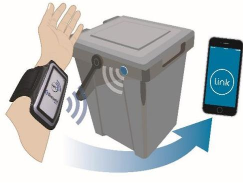
Figura 2. Cubos con chips NFC en la entrada de un edificio de un municipio de la Segarra, Cataluña (izquierda); y, muñequera que los operarios llevan al realizar la recogida (derecha). Fuente: Consell Comarcal de la Segarra y Xarxa Ambiental, 2018.
