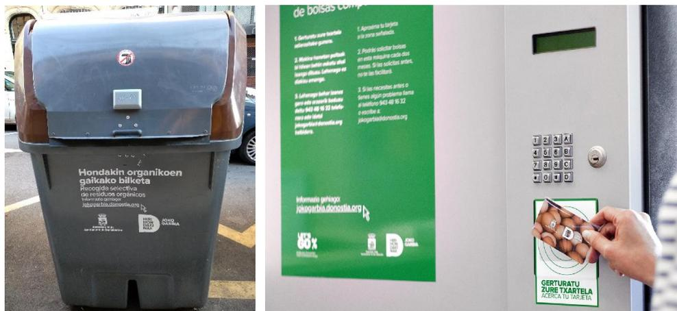
Figura 3. Contenedor con cerradura de apertura mediante tarjeta electrónica (izquierda); y, máquina expendedora de bolsas compostables en San Sebastián (derecha). Fuente: Institut Cerdà y Ayuntamiento de San Sebastián, 2018.
