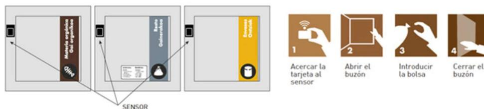
Figura 6. Apertura de los buzones de recogida neumática con tarjeta de la fracción orgánica, resto y envases ligeros. Fuente: Mancomunidad de la Comarca de Pamplona, 2023.
